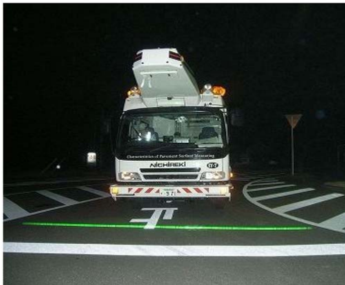
路面性状調査測定車による測定状況
